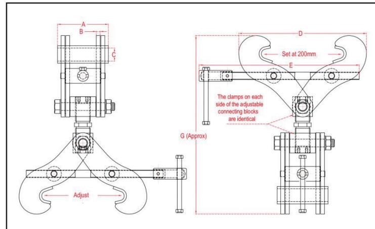
**ADJUSTABLE DOUBLE ENDED 'SUPERCLAMP' MONORAIL CONSTRUCTION CLAMPS**
